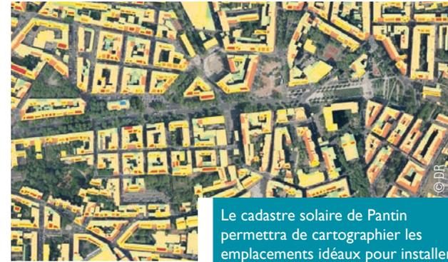
Le cadastre solaire de Pantin permettra de cartographier les emplacements idéaux pour installer des panneaux solaires.
