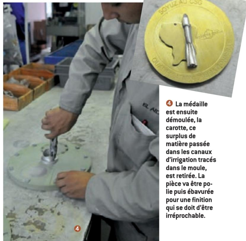
4 La médaille est ensuite démoulée, la carotte, ce surplus de matière passée dans les canaux d'irrigation tracés dans le moule, est retirée. La pièce va être polie puis ébavurée pour une finition qui se doit d'être irréprochable.
